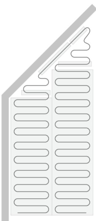
W miejscach gdzie nie można ułożyć maty grzejnej – przewód maty można odłączyć od siatki lub ciąć siatkę na wąskie paski, tak aby umożliwić dowolny sposób układania przewodu.
