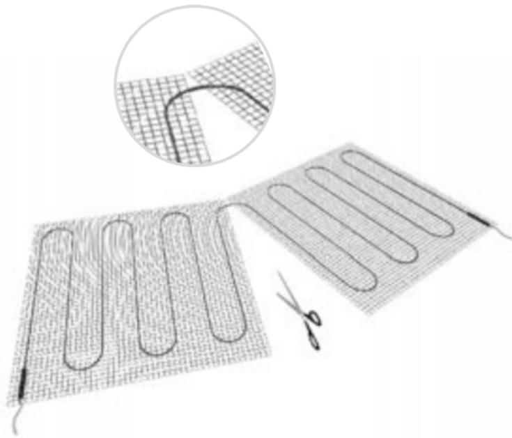
Мат следует разложить по размеру и форме обогреваемой поверхности
