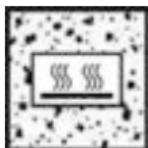
Instalacja w warstwie kleju do płytEK lub masie samopoziomującej
