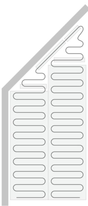
Мат следует разложить по размеру и форме обогреваемой поверхности.
