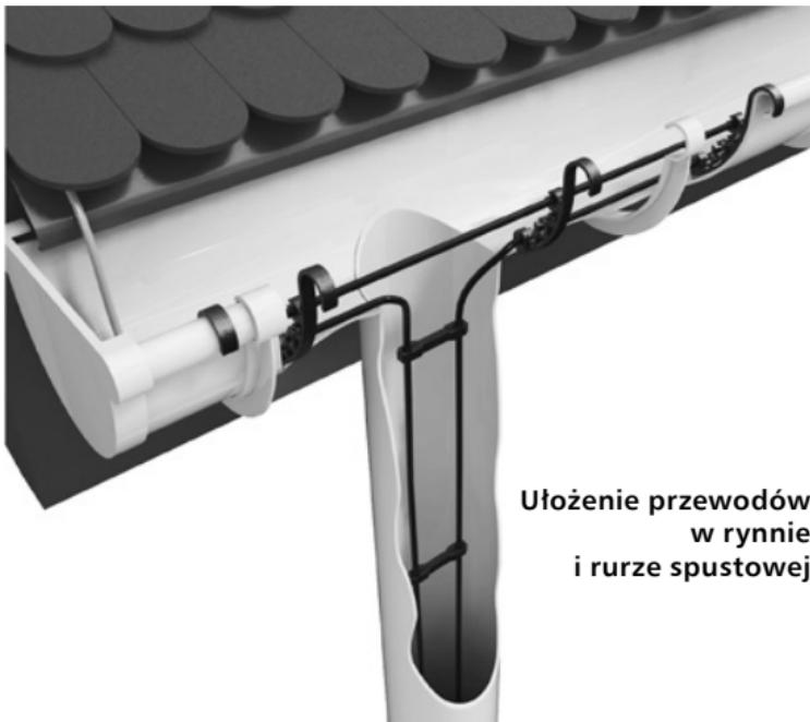
Miejsce połączenia rynny i rury spustowej należy zabezpieczyć płaskownikiem montażowo-ochronnym, by zapobiec ewentualnym uszkodzeniom przewodu.
