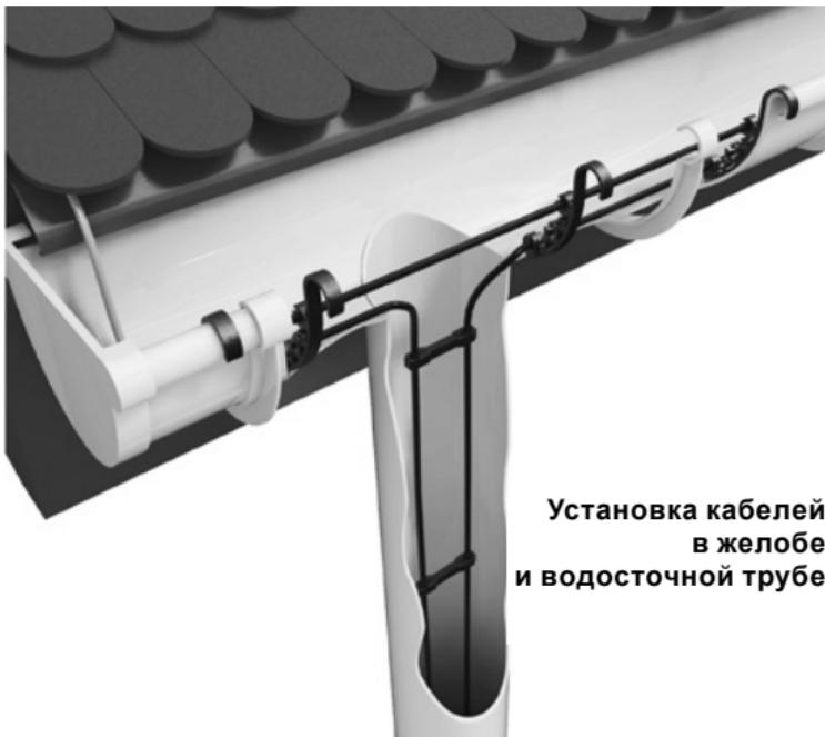
Для предотвращения механического повреждения кабеля в зоне перехода из желоба в водосточную трубу требуется использовать специальную монтажную пластину.
