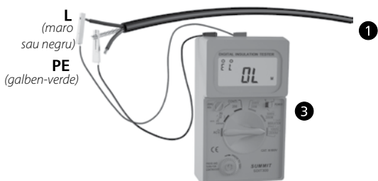
Măsurători de rezistență a izolației
